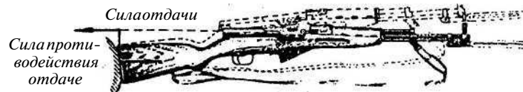
Подбрасывание дульной части ствола вверх при выстреле в результате действия отдачи
