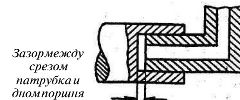
Варианты исполнения поршня газоотводного устройства: а — поршень входит внутрь газовой камеры; б — поршень находит на стенку патрубка газовой камеры
