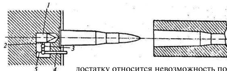
Действие данного механизма заключается в том, что, когда затвор ударится о пенек ствола, стержень продвинется назад и при помощи рычага заставит ударник двигаться вперед, при этом ударник разобьет капсюль патрона.
