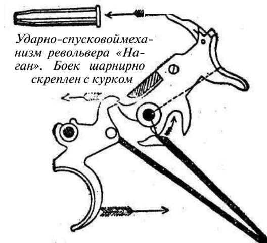
Ударно-спусковой механизм револьвера «Наган». Боек шарнирно скреплен с курком
